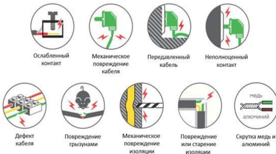
Рисунок 6. Возможные причины искрения в электропроводке
